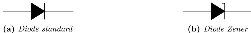
Figure 1 – Symboles d'une diode standard (1a) et Zener (1b). Le triangle indique le sens direct de polarisation.
